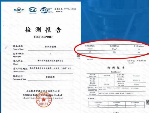
铝料系统 - 拉伸测试 Aluminum material system - Tensile test
